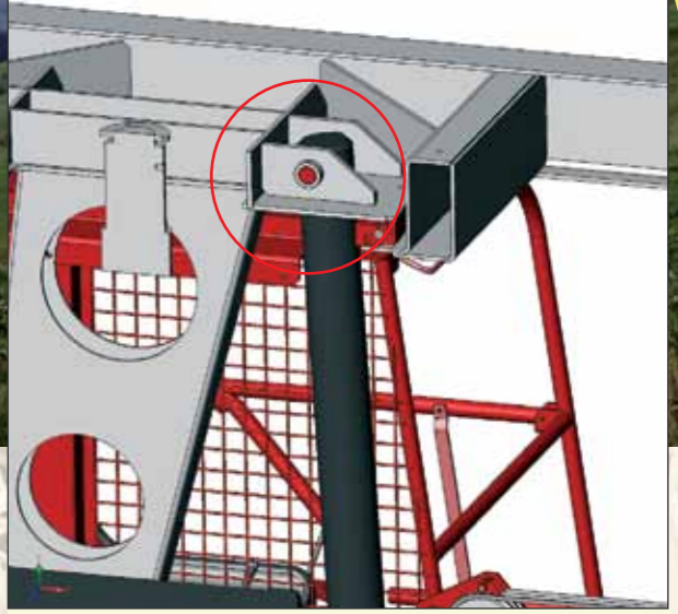
Hubkraft direkt von oben auf den Drehkranz geleitet
